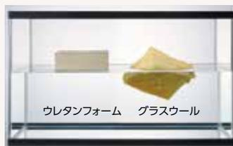
グラスウール(右)は水が染み込み約3分の2沈んでしまいました。ヒートコアパネルに使用している硬質ウレタンフォーム(左)は水を通しにくい素材であることが確認できます。
